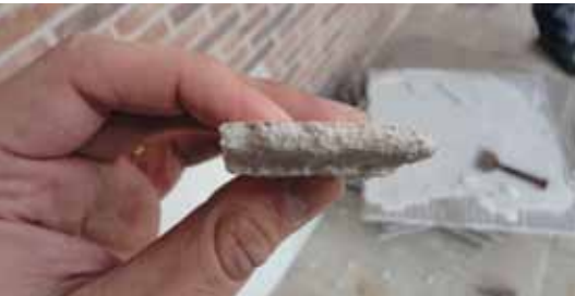
Afb. 1 De bindmiddel huid blijft kleven aan de tegellijm.
